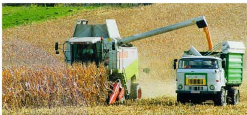
Der LKW L 60 Frank Rabold als selbstfahrender Überladewagen. Hinter dem Fahrerhaus die eingeknickte Ladeschnecke.
